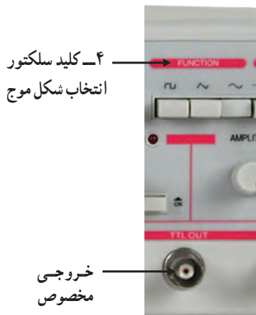
شکل ۱۰۱-۲ کلید سلکتور انتخاب شکل موج
