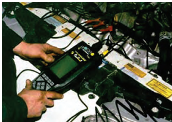
شکل ۱۹۴-۲ یک نمونه دستگاه اسکنر کوچک دستی
