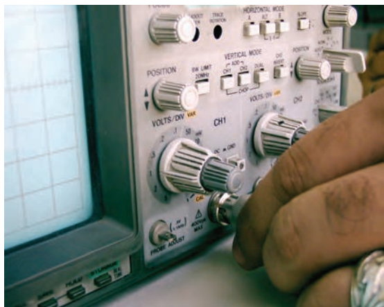
شکل ۱۱۴-۲ نحوه‌ی اتصال BNC به اسیلوسکوپ
