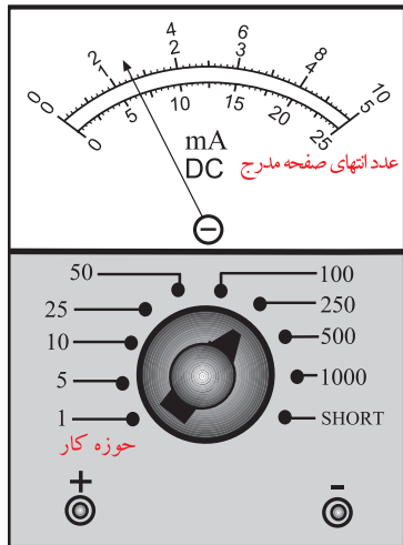
شکل ۱-۵۴- تمرین برای محاسبه جریان ولت متر آنالوگ
