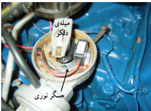
شکل ۱۴۵-۲- سه نمونه حسگر استفاده‌شده در سیستم جرقه‌زنی
