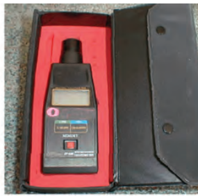
دورسنج دیجیتالی با محرک مکانیکی
