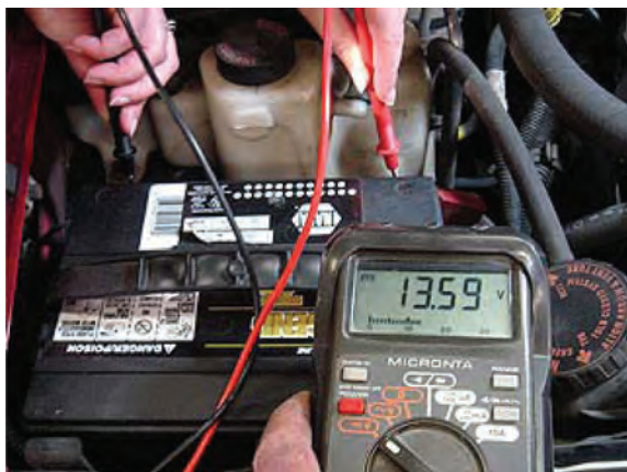
شکل ۱-۵۰ اندازه‌گیری ولتاژ با ولت‌متر دیجیتال
