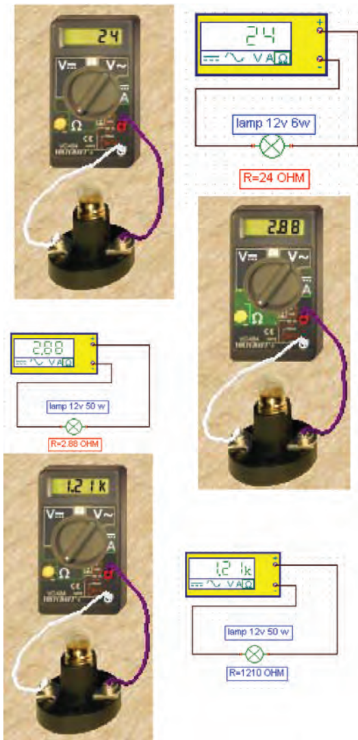
شکل ۸۹-۲- اندازه گیری مقاومت لامپ‌های روشنایی
