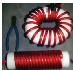
سلف پیچیده شده روی قرقره بدون هسته
