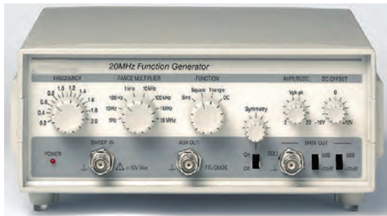
شکل ۵-۲- دو نمونه سیگنال ژنراتور AF
