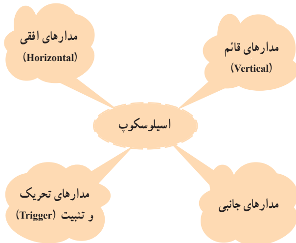
شکل ۱۲۰-۲- مدارهای موجود در اسیلوسکوپ
